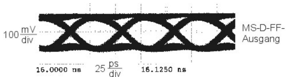
Abb. 4.37: Ausgang des Komparators und des MS-D-FFs bei 10 Gbit/s.
